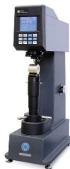
Die Prüfung wird durchgeführt, indem eine spezifizierte Kugel mit Kraft auf die vorbereitete Oberfläche gedrückt wird. Der Durchmesser der Eindruckstelle gibt Aufschluss über die Härte. Siehe nachstehendes Beispiel:
